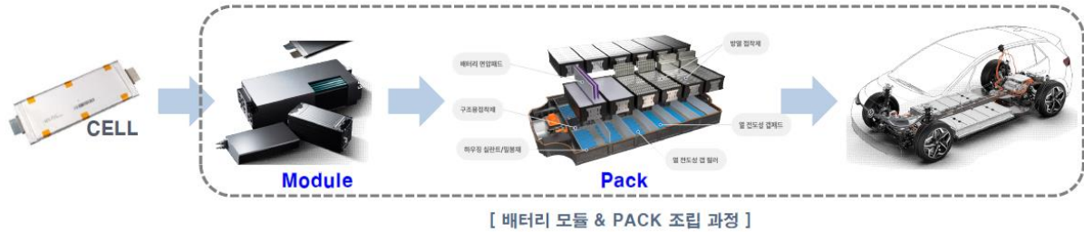
그림 8 배터리 모듈 & Pack 조립 과정
